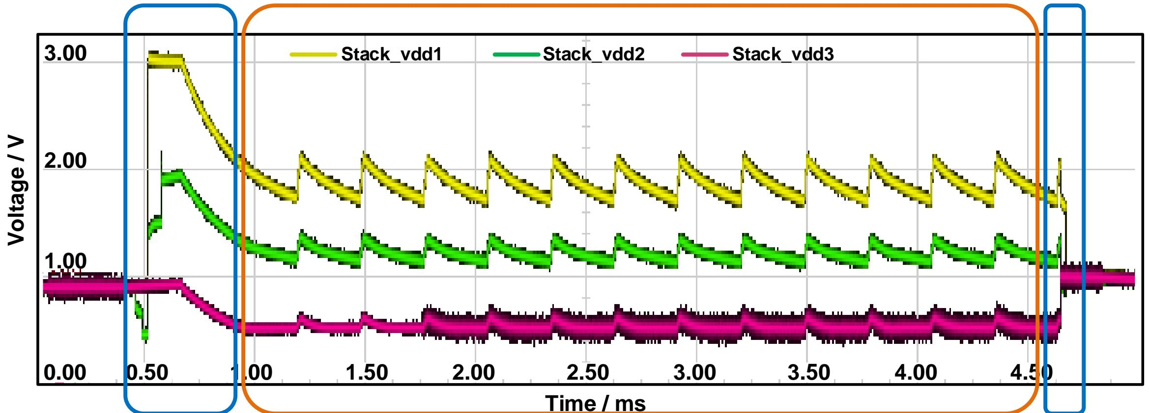
Stack\_vdd1: SRAM1 VDD\_RAM / Stack\_vdd2: SRAM2 VDD\_RAM / Stack\_vdd3: X032 & RTC VDD
